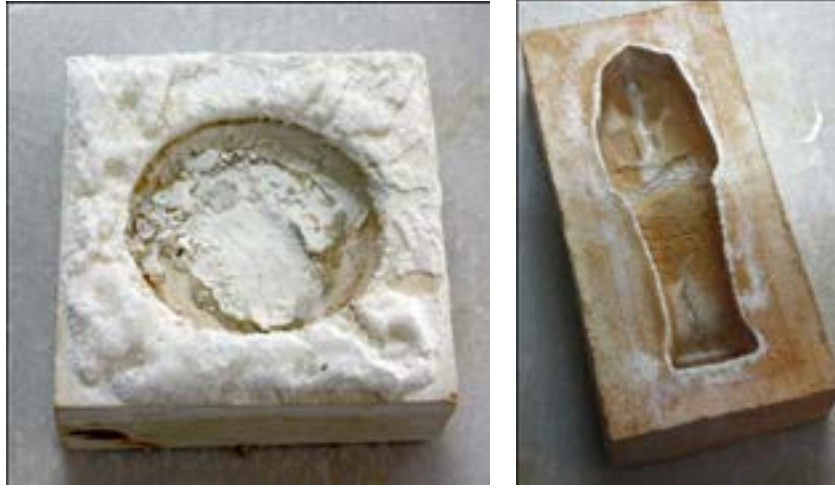
Görsel 5: Mısır pastası alçı kalıbında kullanıldığında alçının tepkisi Görsel 6: Uygulama çalışmasında Uşhabti figürü için pişmiş kilden kalıp yapılmıştır
