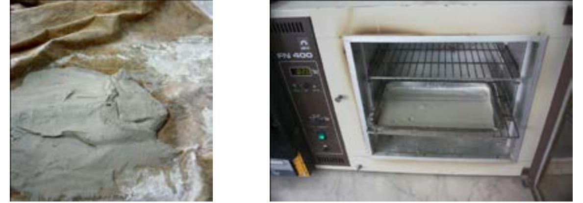
Görsel 7: Mısır pastası kurutma şekli 1: bezle kurutma Görsel 8: Mısır pastası kurutma şekli 2: etüv içinde metal tepside
