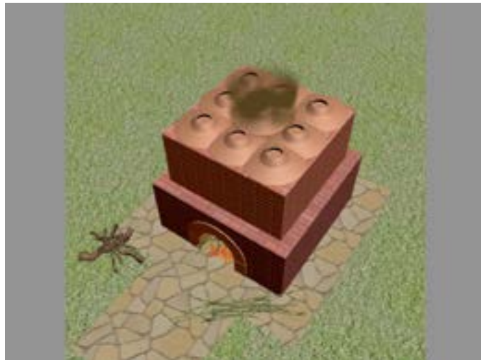
Görsel 6: Piccolbasso'nun tanımladığı lüster fırınının temsili çizimi, (3D tasarım Kamuran ÇİZER) (Kaynak: Çizer, 2010, s.162)
